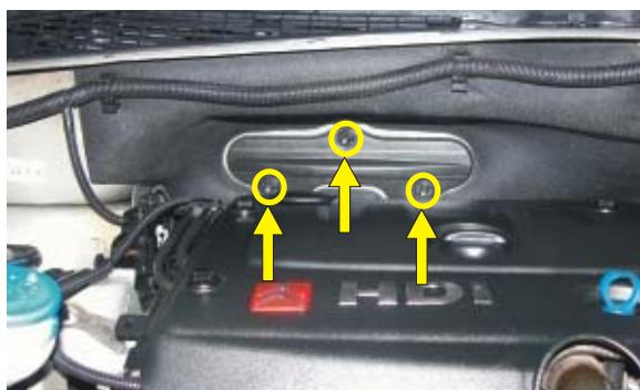
**(PL)** Odkręcić wkręty pokrywy filtra, usunać pokrywę
